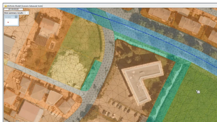
Terrainabhängige Dreiecksvermaschung in InfoWorks ICM
